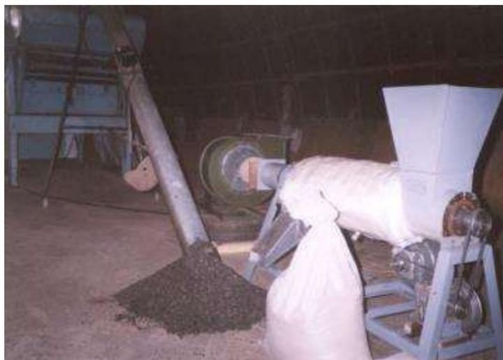
Рисунок 4.34 - Технологическая линия подработки семян подсолнечника
