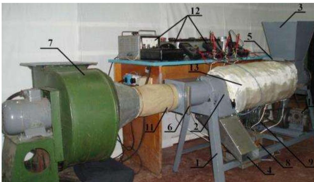
Рисунок 4.7 – УТОЗ 1 при проведении лабораторных исследований: 1 – рама; 2 – кожух; 3 – бункер загрузочный; 4 – лоток выгрузной; 5 – заслонка; 6 – шибер; 7 – вентилятор; 8 – выпрямитель тока; 9 – электродвигатель; 10 – редуктор; 11 – воздуховод; 12 – комплект измерительных приборов; 13 - теплообменник
